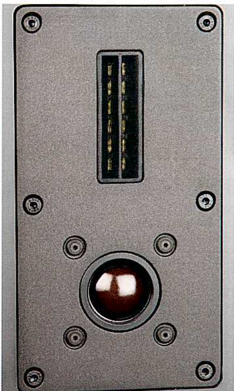
Dalissa magnetostaattinen elementti kytkeytyy kalotin rinnalle korkeimmilla taajuuksilla.
