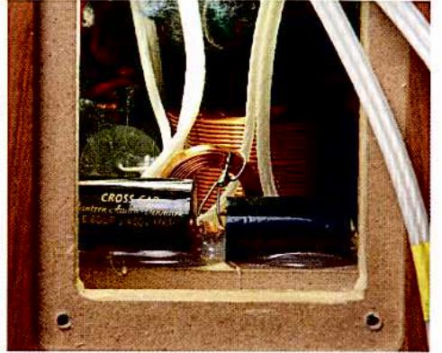
ESAn jakosuotimessa on käytetty ilmasydänkeloja ja Jantzen Audion polypropyleenikondensaattoreita.
