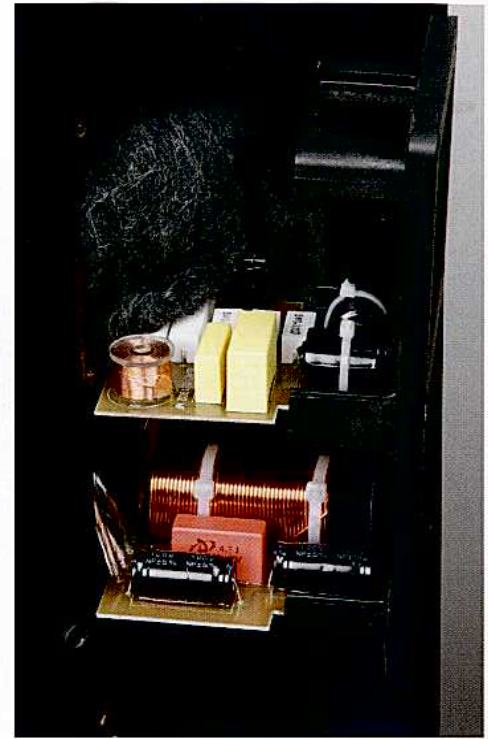
Elac on sijoittanut jakosuotimen neljälle eri piirilevyille. Yhdellä niistä on tuotantoa varten tehtyjä tason hienosäätöjä.
