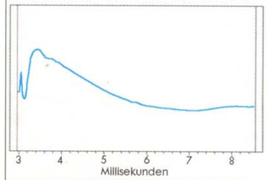
Der Frequenzschieb dieses Superwandlers ist sehr ausgeglichen. Nur im Hochton um 20 Kilohertz stört noch ein kleiner Peak. Umso überzeugender das enorme Bassfundament, das bis 40 Hertz hinunterreicht, was auch im Hörtest gut nachzuvollziehen war. Die Impedanz liegt im Mittel bei zirka acht Ohm. Die Sprungantwort ist sauber und ausgeglichen.
