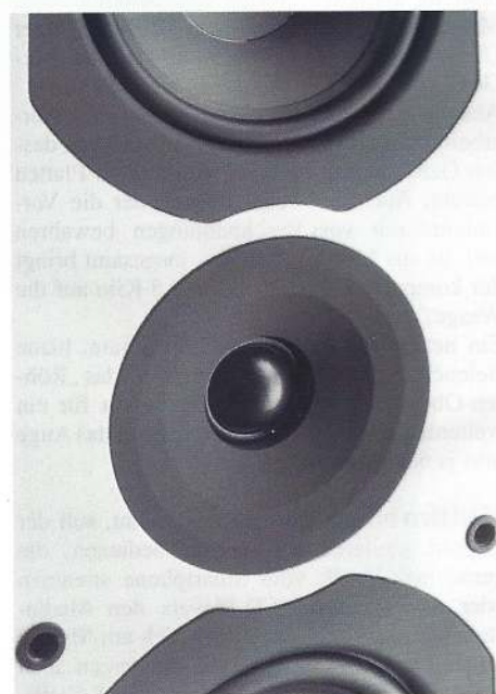
Ein Waveguide vor dem Hochtöner hilft beim Übergang zum Tiefmitteltöner und sorgt für ein optimiertes Abstrahlverhalten
