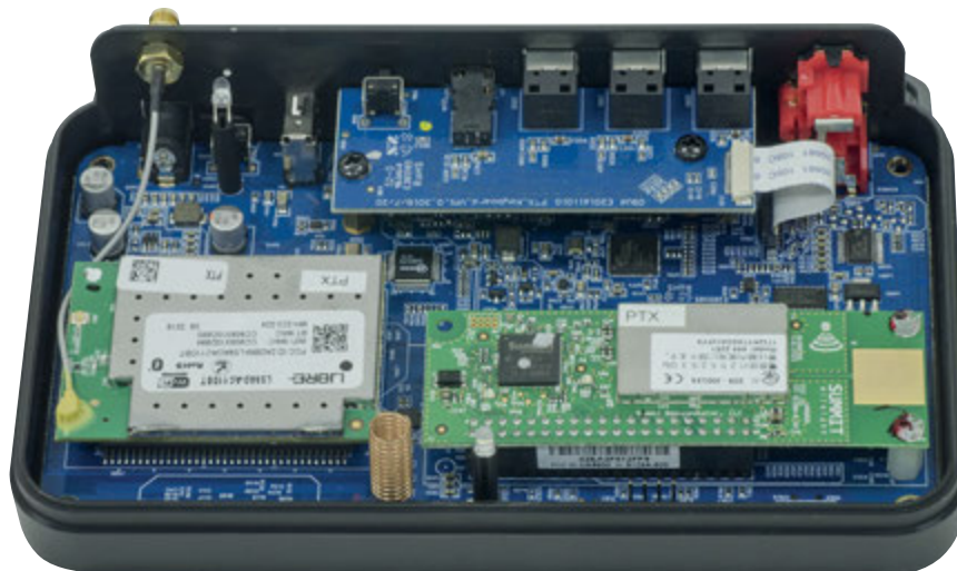
Lo Stereo Hub è realizzato in maniera impeccabile; all'interno si riconosce tra l'altro il convertitore A/D PCM1863 della Texas che lavora sui due ingressi analogici.
