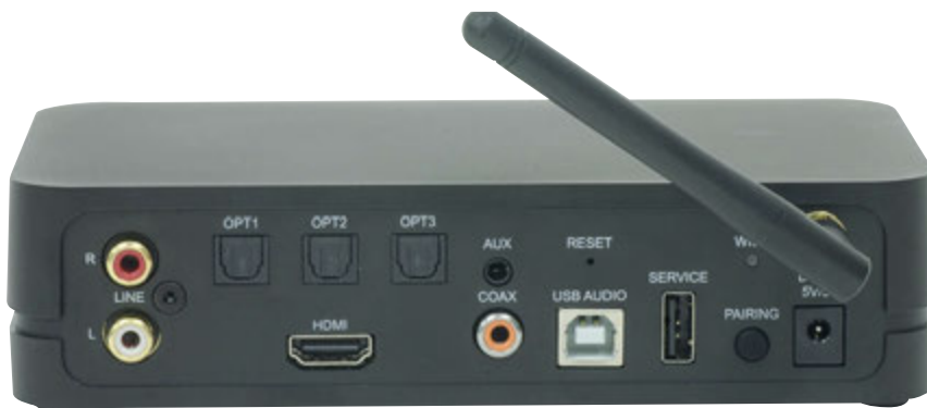
Solo ingressi, sia analogici (due, un RCA ed un mini-jack) sia digitali (6 quelli visibili: HDMI ARC, 4 S/PDIF, USB-B; 2 quelli invisibili: Bluetooth e Wi-Fi) sul retro dell'apparecchio, che comunica in wireless nello standard WiSA con sistemi di altoparlanti compatibili.
